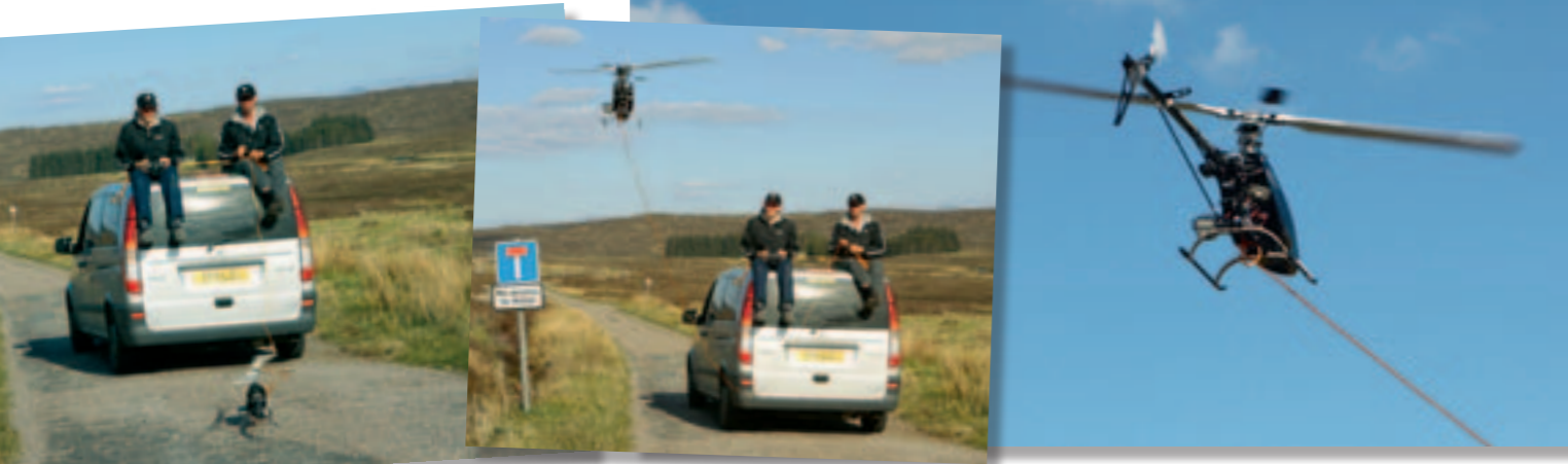
Das Abheben erfolgte aus eigener Kraft, sprich durch den E-Antrieb des Helis. Dabei wurde die Drehzahl mit 1.500 Umdrehungen pro Minute schon weitgehend moderat gewählt; mit etwas Glück könnte hier schon ein Auftouren bei Fahrt festgestellt werden
