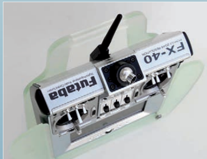
◀ ▲ Das 2,4-GHz-Sendermodul wirkt an der FX-40 sehr aufgeräumt – und spätestens auf den zweiten Blick lernt man die gute Zugänglichkeit von außen zu schätzen, die insbesondere dann von großem Vorteil ist, wenn man im 2,4 GHz/35 MHz-Mischbetrieb fliegt. Die Senderantenne sollte idealerweise leicht zur Seite und nach unten abgewinkelt sein, nicht jedoch nach vorn auf das Modell zielen. ▼
