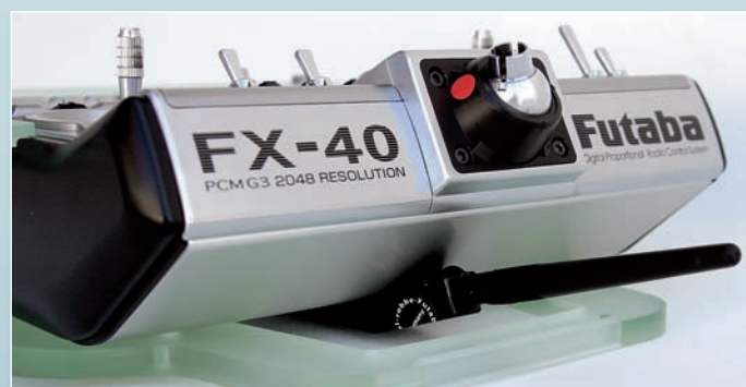
◀ ▲ Das 2,4-GHz-Sendermodul wirkt an der FX-40 sehr aufgeräumt – und spätestens auf den zweiten Blick lernt man die gute Zugänglichkeit von außen zu schätzen, die insbesondere dann von großem Vorteil ist, wenn man im 2,4 GHz/35 MHz-Mischbetrieb fliegt. Die Senderantenne sollte idealerweise leicht zur Seite und nach unten abgewinkelt sein, nicht jedoch nach vorn auf das Modell zielen. ▼
