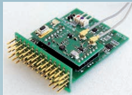
◀ Der R6014FS ist das derzeitige Flaggschiff der FASST-Empfängerflotte. Mit 2.048 Schritten verfügt das System über eine gute Auflösung, und die Übertragungsgeschwindigkeit ist sogar noch ein Stück besser als bei PCM-G3. Wem die 14 Servokanäle zu viel sind, kann problemlos eine kleinere Empfängervariante aus dem robbe-Programm wählen. Man beachte übrigens den speziellen Koaxial-HF-Stecker, mit dem die Antennen auf der Empfängerplatine angebracht sind; mit etwas Geschick kann man im Fall der Fälle selbst die Antennen tauschen. ▼
