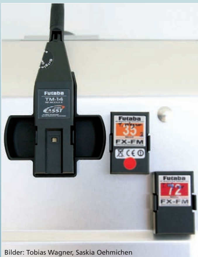
◀ ▲ Das 2,4-GHz-Sendermodul wirkt an der FX-40 sehr aufgeräumt – und spätestens auf den zweiten Blick lernt man die gute Zugänglichkeit von außen zu schätzen, die insbesondere dann von großem Vorteil ist, wenn man im 2,4 GHz/35 MHz-Mischbetrieb fliegt. Die Senderantenne sollte idealerweise leicht zur Seite und nach unten abgewinkelt sein, nicht jedoch nach vorn auf das Modell zielen. ▼
