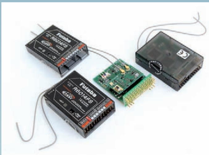
◀ Der R6014FS ist das derzeitige Flaggschiff der FASST-Empfängerflotte. Mit 2.048 Schritten verfügt das System über eine gute Auflösung, und die Übertragungsgeschwindigkeit ist sogar noch ein Stück besser als bei PCM-G3. Wem die 14 Servokanäle zu viel sind, kann problemlos eine kleinere Empfängervariante aus dem robbe-Programm wählen. Man beachte übrigens den speziellen Koaxial-HF-Stecker, mit dem die Antennen auf der Empfängerplatine angebracht sind; mit etwas Geschick kann man im Fall der Fälle selbst die Antennen tauschen. ▼
