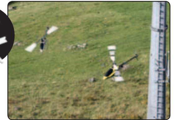
Dünne Luft: Nach einigen Minuten im Lift geht die Akku-Power rapide zu Ende, der Regler der 6s-Maschine beginnt das pulsierende Abschalten. Das Ziel der Mission heißt fortan Überleben
